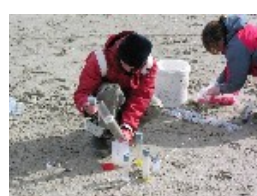
pobierania próbek próbnikiem rurowym
