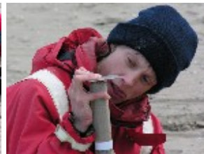
Dividindo as amostras em camadas de 1 cm
